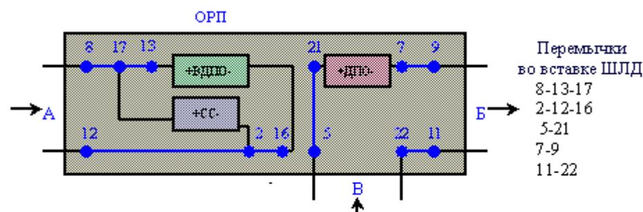
9. С направления А в направление В при отсутствии ячейки ВДПР с включением дополнительного шлейфа по направлению В (Т-образная схема)
