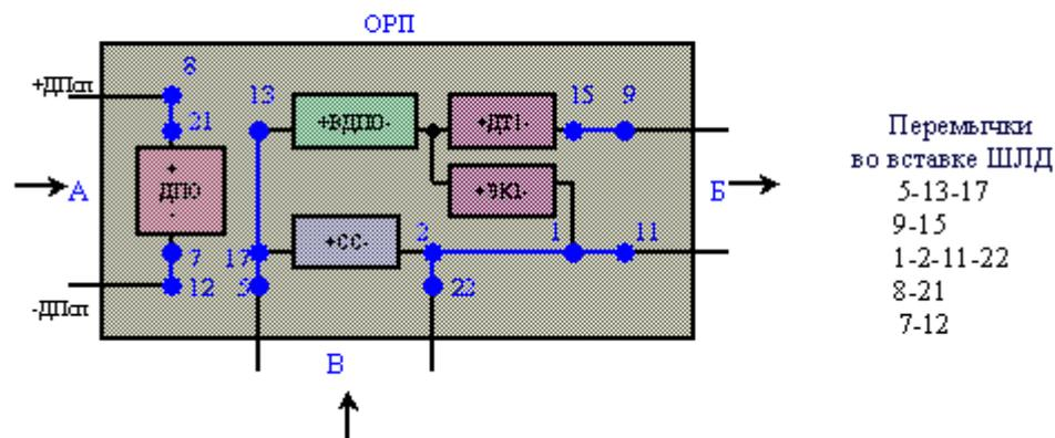
8. С направления А в режиме окончания ДП и при отсутствии ячейки ВДПР, с организацией транзита ДП с направления В на Б с включением датчика ответвления по ДП
