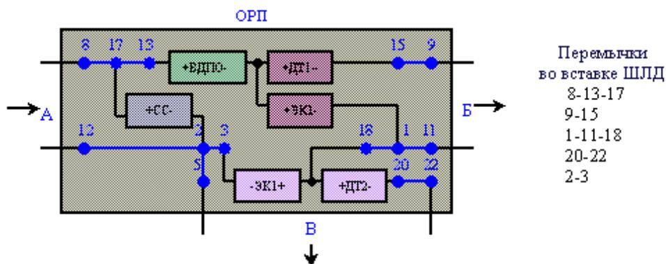
10. С направления В в направление А при отсутствии ячейки ВДПР с включением дополнительного шлейфа по направлению В (Т-образная схема)
