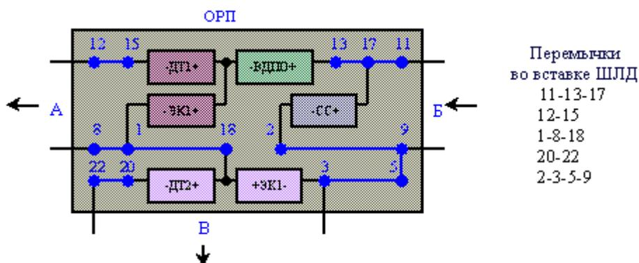
11. С направления В в направление А при отсутствии ячейки ВДПР с включением дополнительного шлейфа по направлению В (Т-образная схема)
