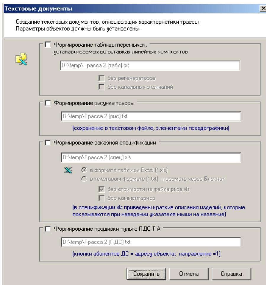
Программа осуществляет формирование таблицы перемычек, устанавливаемых во вставках линейных комплектов аппаратуры, в зависимости от выбранных пользователем в программе параметров объектов.
