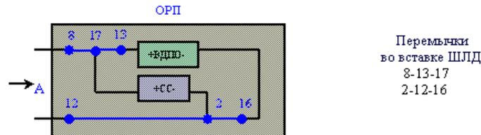
3. С направления Б в направление А с включением ячейки ВДПР
