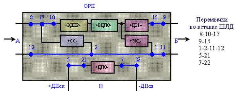
2. С направления А в режиме окончания ДП и при отсутствии ячейки ВДПР
